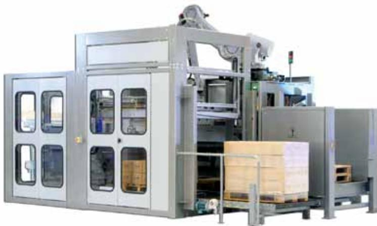
**Optima Nonwovens:** Neben den flexiblen Primärverpackungsmaschinen bildet das Maschinenangebot inzwischen die komplette Prozesskette ab bis hin zum spezifisch auf Nonwovens-Produkte ausgelegten Palettierer.
